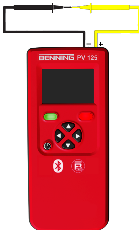
Abb. 8: Nullabgleich der 4 mm- Sicherheitsmessleitungen
