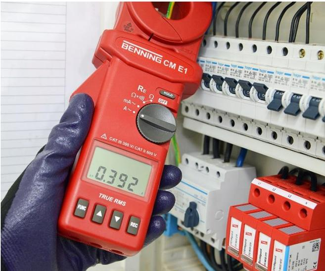
Messung des Gesamt-Ableitstroms in einer Unterverteilung.
